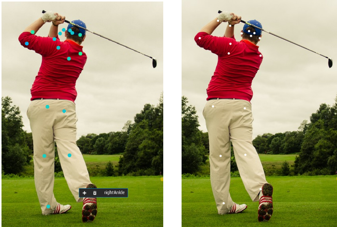
Figura 2.1: A sinistra un'immagine in seguito alla Pose Detection effettuata dal modello PoseNet. A destra la stessa immagine dopo aver corretto manualmente le posizioni inserite con imprecisione dal modello.
